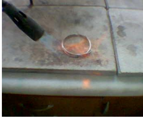
Resim 12: Telin tavlama işlemi
