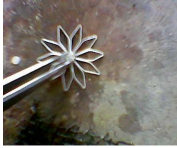
Resim 16: Çatı teline toz kaynak koyma
