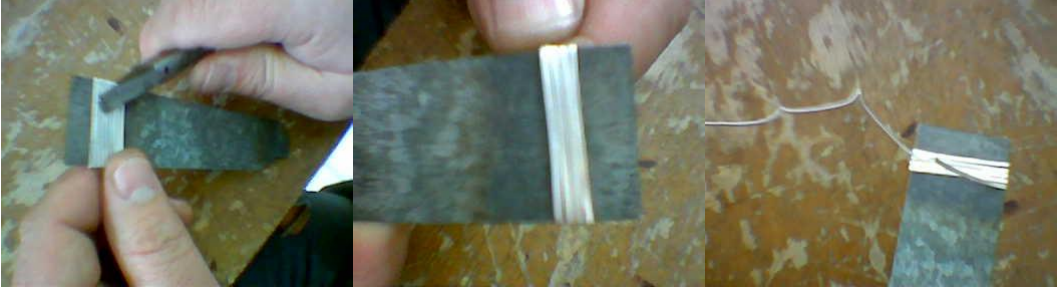
Resim 13: Telin teneke kalıba sarılması ve çıkarılması
