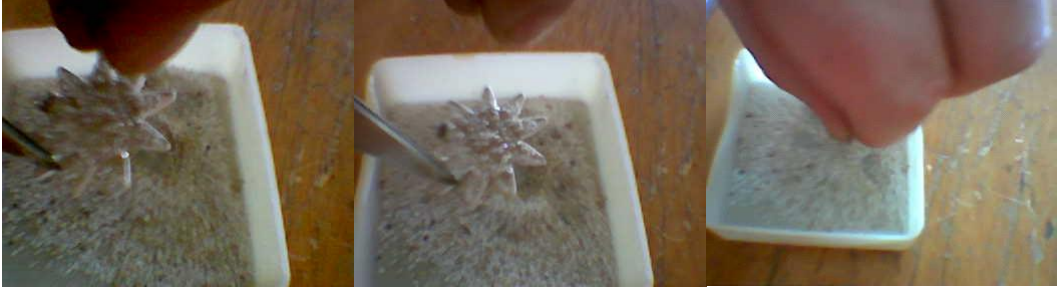
Resim 23: Toz kaynağın serpilmesi
