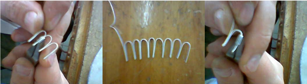
Resim 14: Tele tarak şeklinin verilmesi
