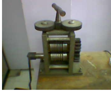
Resim 4: Tel (oluklu) silindiri
