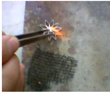
Resim 17: Modele kaynak yapma
