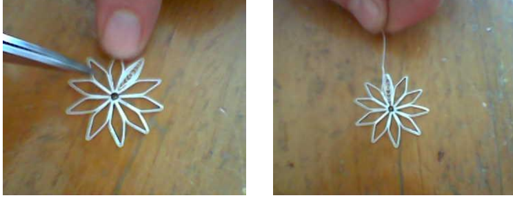
Resim 25: Telkarinin çatıya göre şekillendirilip yerleştirilmesi
