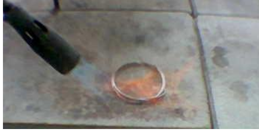
Resim 21: Telin tavlama işlemi
