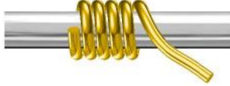
Resim 3.1: Telin halka halinde sarılması
