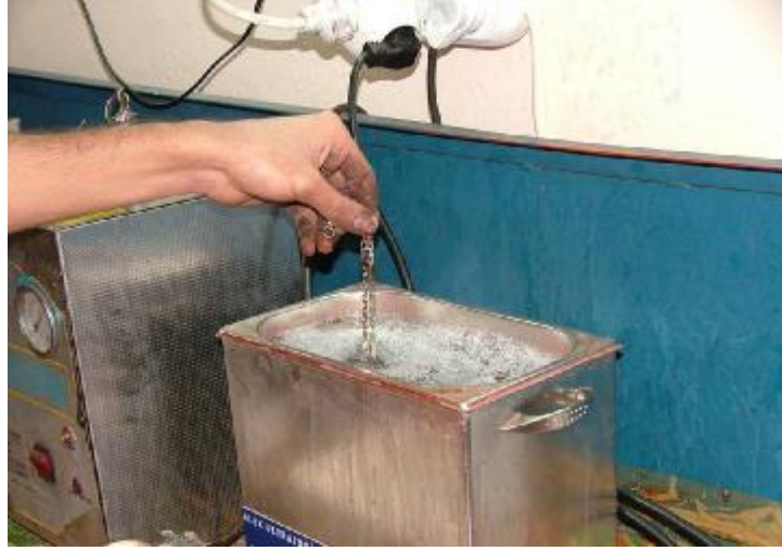
Resim 1. 2: Ultrasonik yıkama makinesinde yapılan yıkama işlemi
