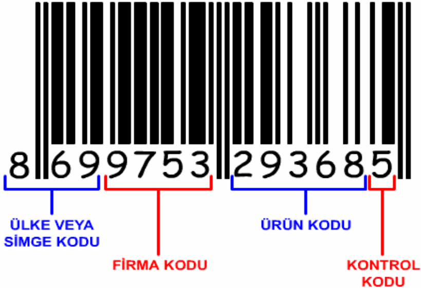
Şekil 3.1. Çubuk kodlamanın ifade ettiği çizgi aralıkları
