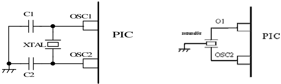
Şekil 1.6: Kristal ve rezonatorün PIC'e bağlantısı
