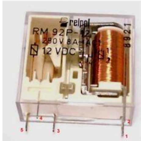
Şekil 1.3: Mekanik röle ve bacak numaraları
