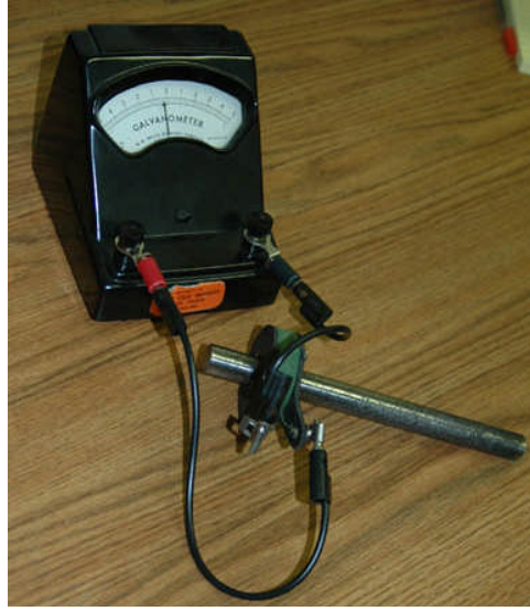
Şekil 1.6: Bir bobinde indüklenen gerilimin galvometre ile ölçülmesi
