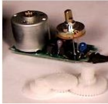
Şekil 2.2: Servo motor iç yapısı
