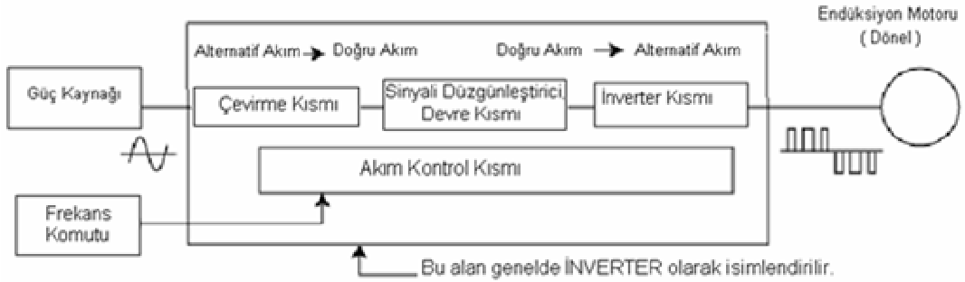
Şekil 2.26: İnverterin temel yapısı
