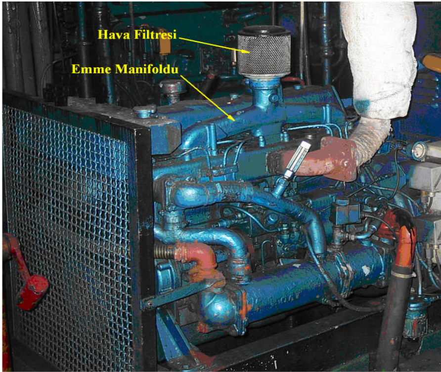
Resim 1.3 Gemide jeneratörü çeviren dizel motoru
