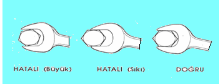
Şekil 1.2: Açık ağız anahtarın cıvataya yerleştirilmesi
