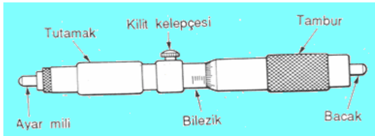
Şekil 1.40: İç çap mikrometresi yapısı ve kısımları
