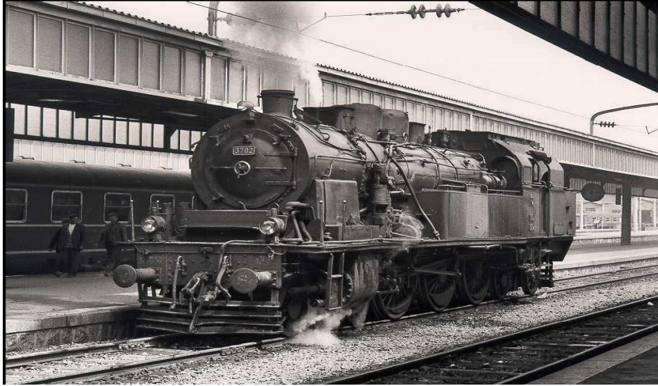
Şekil 1.45: Dıştan yanmalı motorun kullanıldığı bir lokomotif
