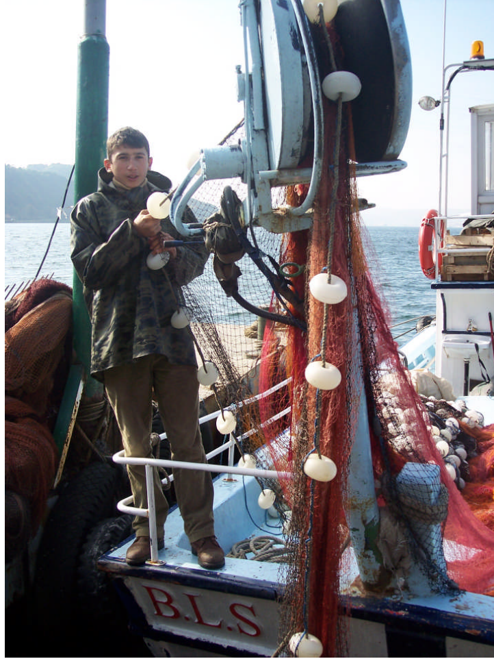
Şekil 3.2:Power blockta ağın toplanması
