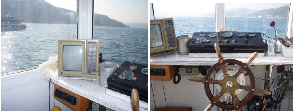
Şekil 1.4: Kaptan köşkü, Echo saunder, Dümen,, Kontrol panosu
