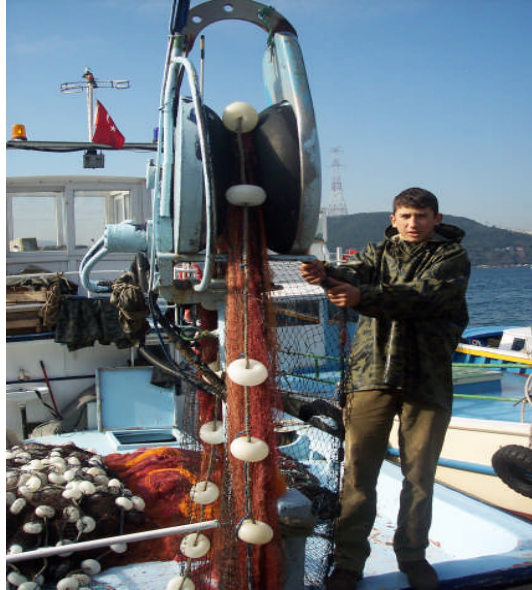
Şekil 3.1: Power blockta ağın toplanması
