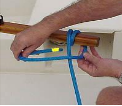
Fotoğraf 7.3: Bantlanmış ve piyan bağı yapılmış kolsuz halat çıması
