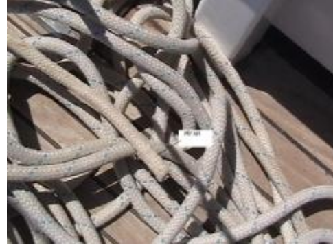
Fotoğraf 7.3: Bantlanmış ve piyan bağı yapılmış kolsuz halat çıması
