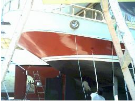
Fotoğraf 3.2: Rulo fırça ile koruyucu tatbiki
