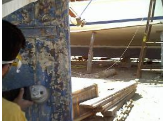
Fotoğraf 3.1:Avuç taşlama motoruyla boyanın sökülmesi
