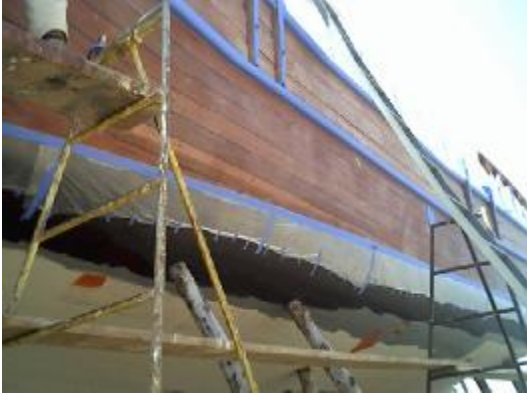
Fotoğraf 1.6: Tiriz çekme işlemi için bantlama
