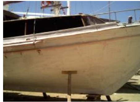
Fotoğraf 1. 5: Macun uygulanmış yüzey
