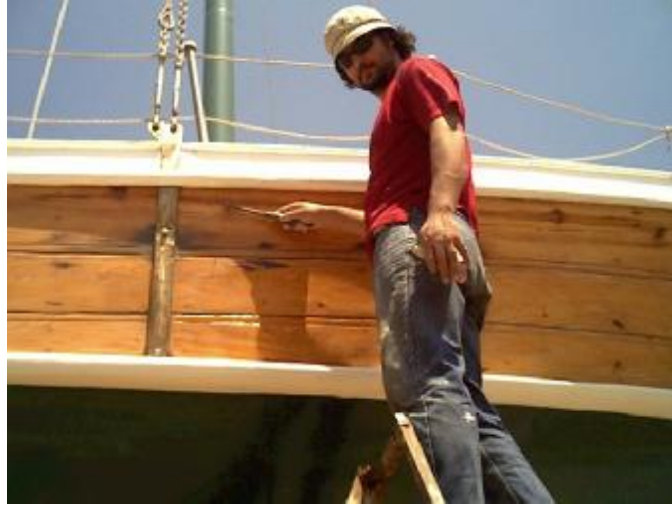
Fotoğraf 1.6: Raspa ile koruyucu kazınma
