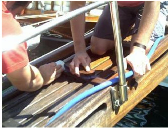
Fotoğraf 2.1: Koruyucusuz tik malzemenin fırçayla temizlenmesi
