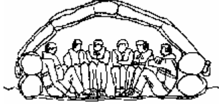
Şekil 7.7: Tabanı söndürülmüş can salı
