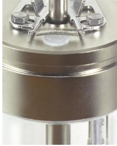
Fotoğraf 1.10: Nansen şişesinin kapanma mekanizması
