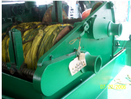
Resim 2. 9: Hidrolik ırgatlar ve çıkırığa sarılmış istinga halatı
