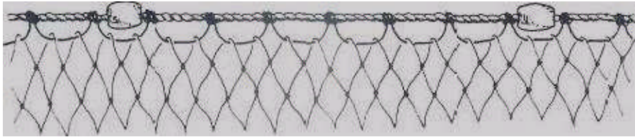
Şekil: 5.3. 32–38 mm göz açıklığındaki uzatma ağlarının mantar yaka donanımı
