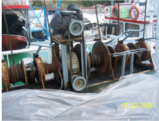
Resim 2.7: Bom direklerinin çalışmasını sağlayan ırgat
