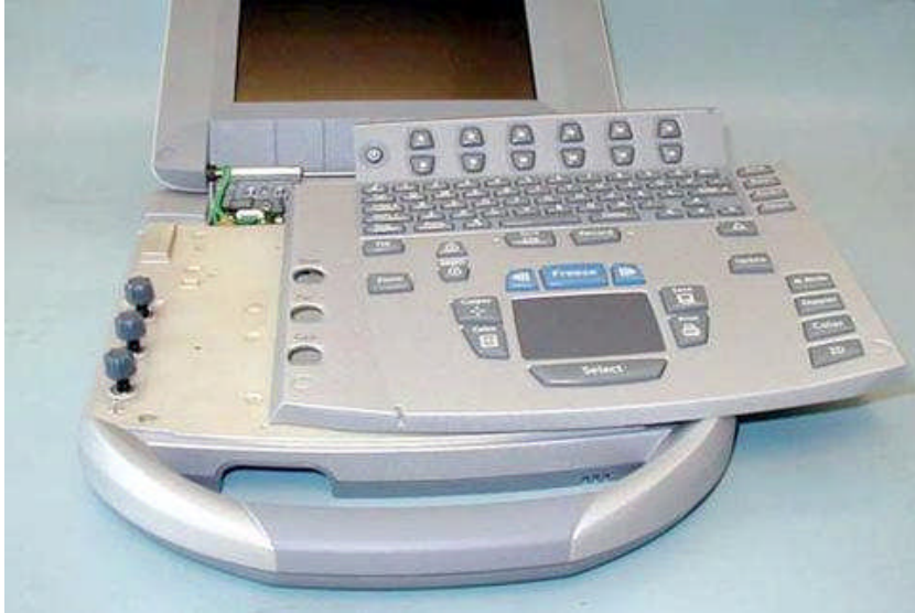
Fotoğraf 2.3: Cihaz üst kapağının sökülmesi
