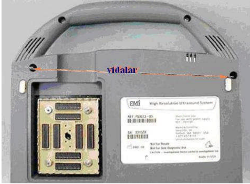
Fotoğraf 2.6: Cihaz alt kapağının sökülmesi
