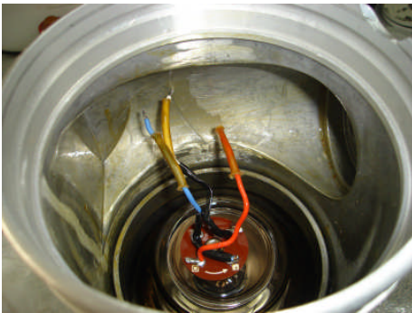
Resim 5.3: Röntgen tüpünün muhafaza içine yerleştirilmesi
