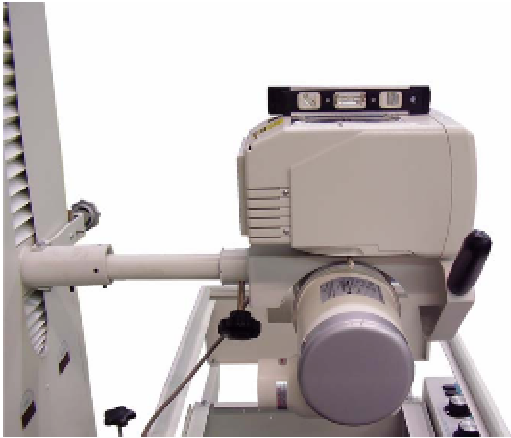
Resim 7.11: Kolimatör düzeyi kontrolü
