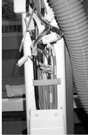
Resim 8.17: Kumanda kablolarının konnektörler yardımı ile bağlanması
