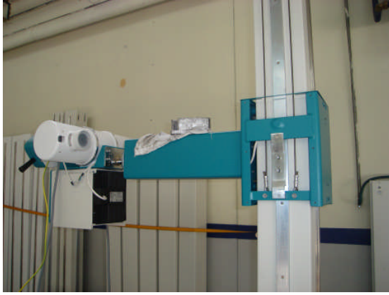
Resim 5.4: Tüp taşıyıcı sütun statife monteli tüp tutucu kol
