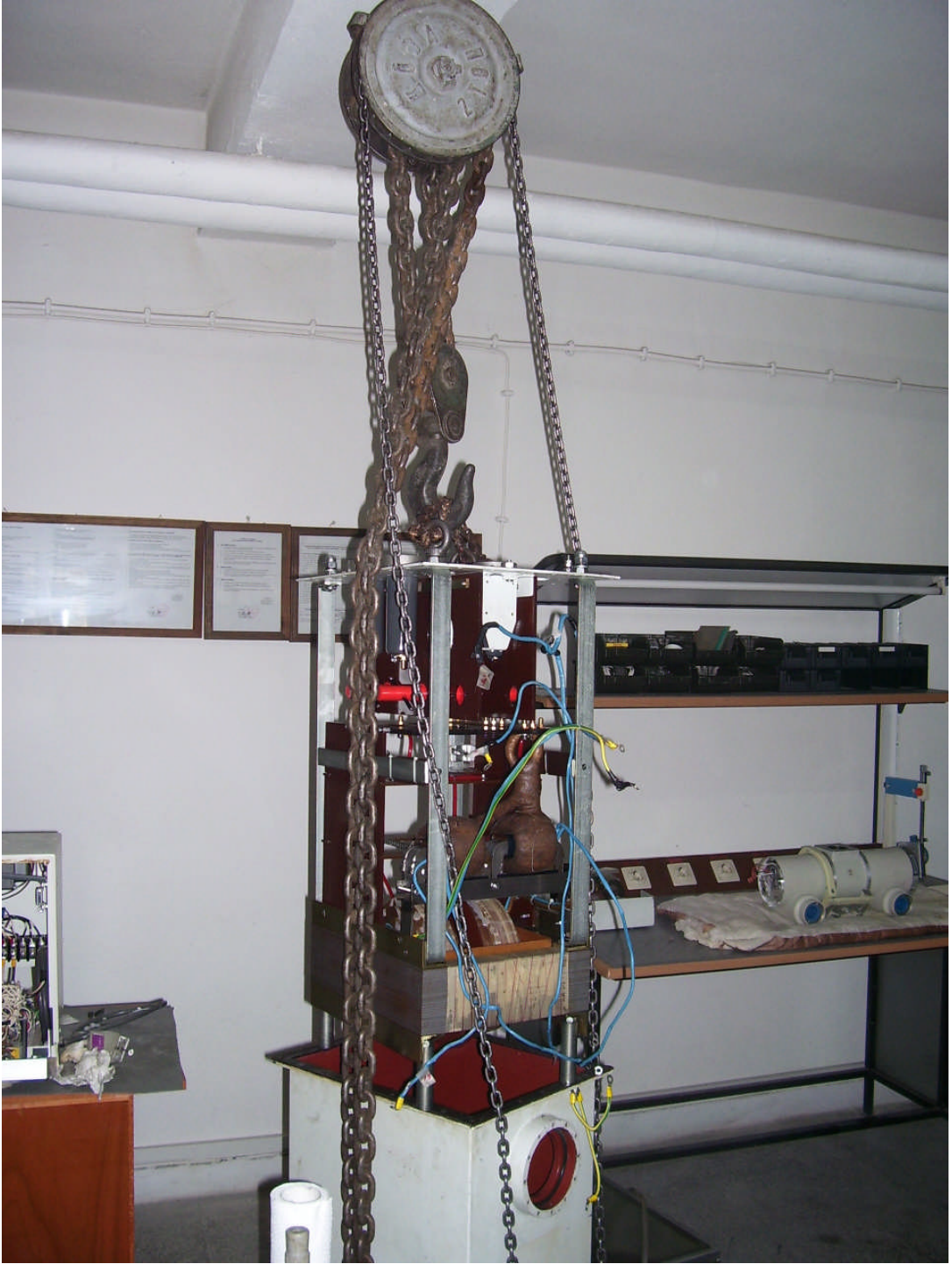
Resim 2.6: Söküm esnasında caraskal kullanımı
