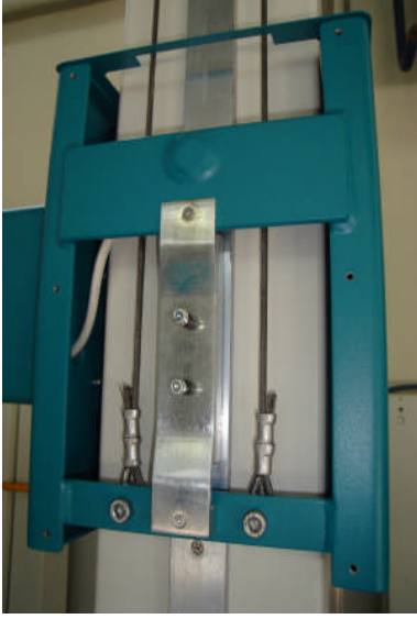
Resim 3.8: Çelik kablo ve bucky taşıma sistemi
