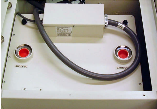
Resim 2.7: YV trafosu girişi
