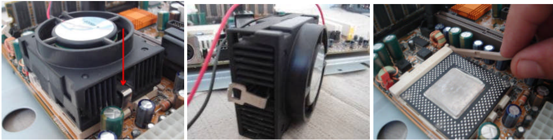
Resim 2.6: ZIF soketten işlemci sökme
