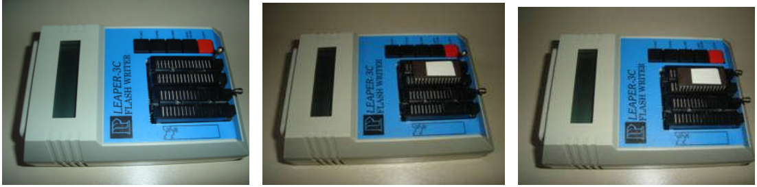
Resim 3.2: EPROM'un programlama cihazına yerleştirilmesi
