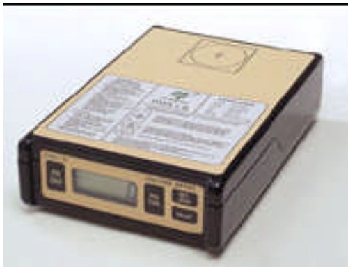
Resim 1.14: PMX-I kVp ve zaman ölçüm cihazı
