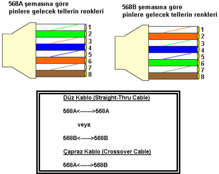
Şekil 2.10: T568A şeması, T568B şeması ve bağlantı tipi
