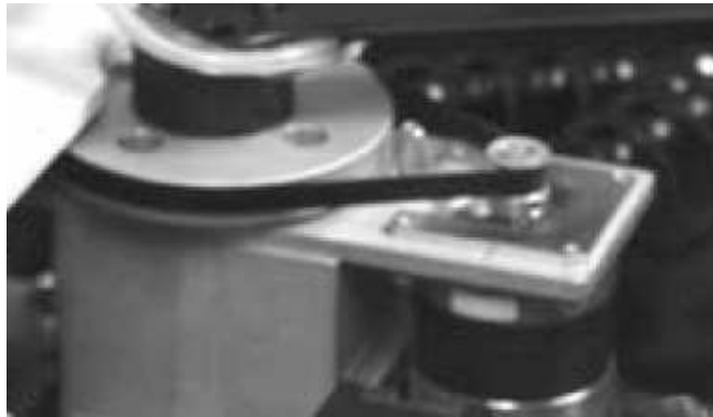
Resim 3.5: Dişli çark ve kayışla hareketin iletilmesi
