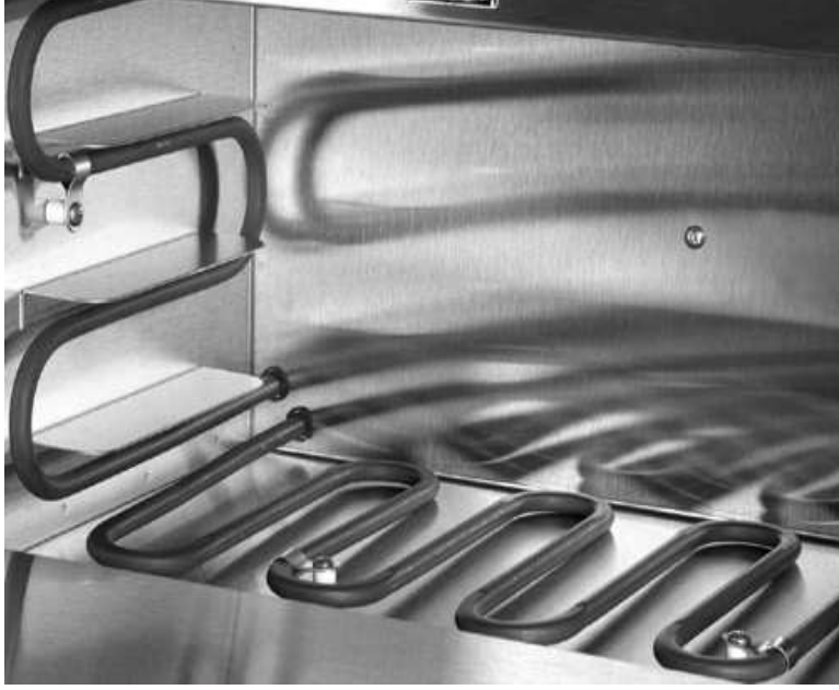
Resim 4.1: Kuru hava sterilizatör kabin içi ısıtıcıları
