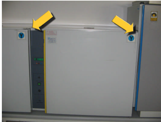
Resim 1.9: Kuru hava sterilizatörünün hatalı yerleşimi
