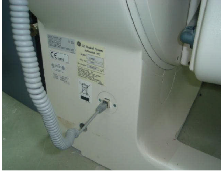
Resim 2.62:Kumandanın gantry ile bağlantısı
