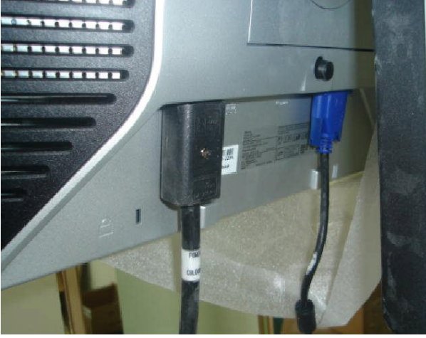
Resim 2.57:Güç kablosu ve ekran kartından gelen kabloların monitör ile bağlantısı
