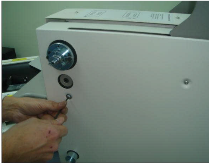
Resim 3.20: Koruma amaçlı metal parçaların bağlantılarının yapılması
