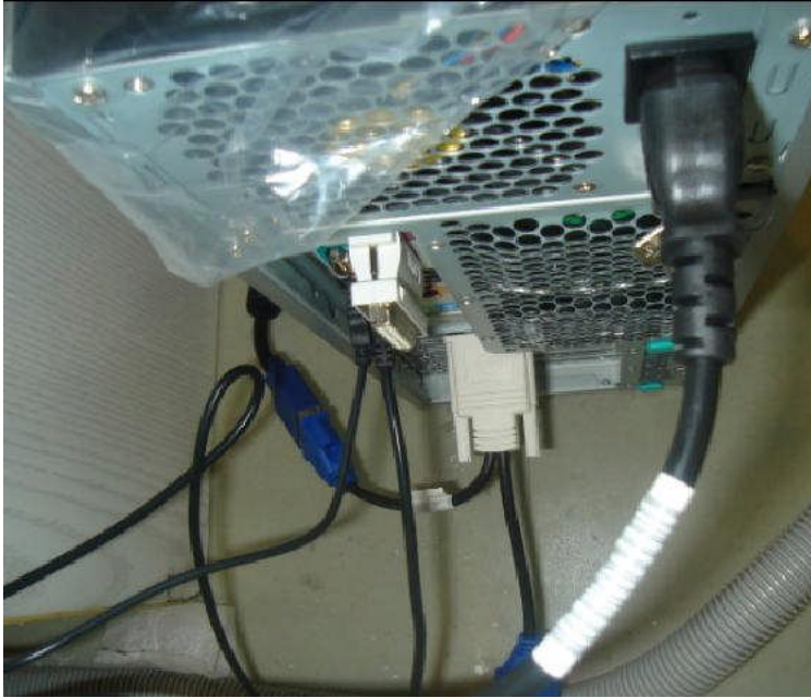
Resim 5.25: Monitörün ekran kartı işe bağlantısı
