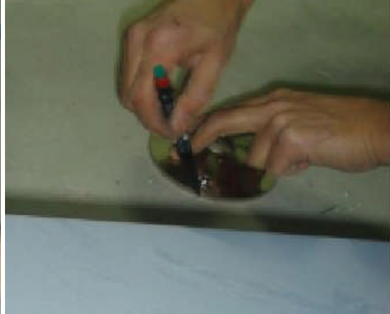
Resim 4.19: Parçanın yerinin belirginleştirilmesi
