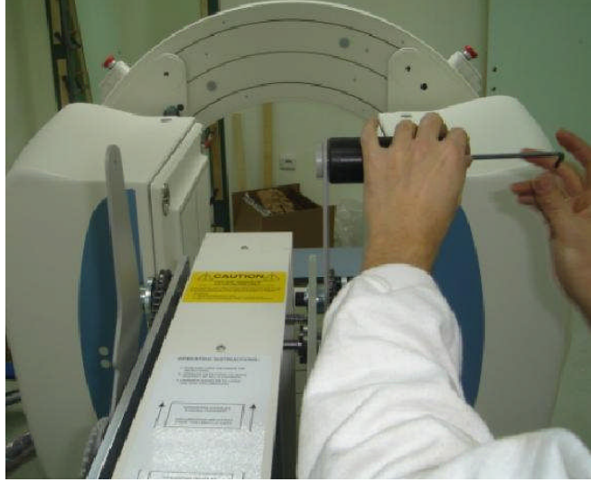
Resim 3.17: Kolimatör arabası Resim 3.18: Kolimatör kilitleme kollarının sökülmesi
