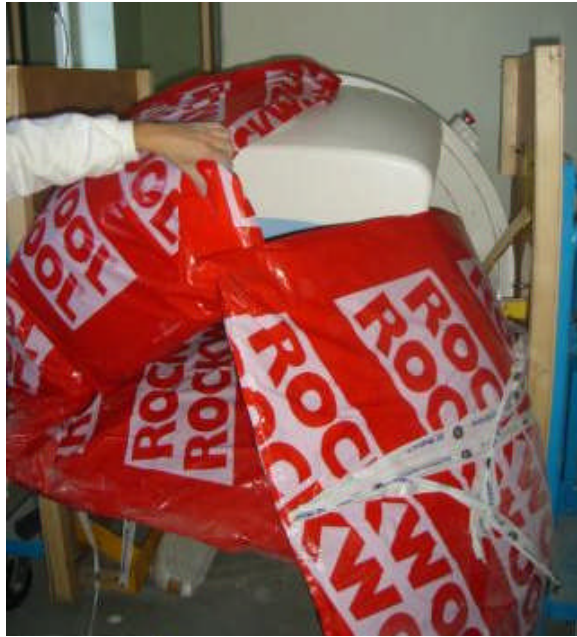
Resim 2.5: Dedektörlerin üzerindeki izocamın çıkarılması
