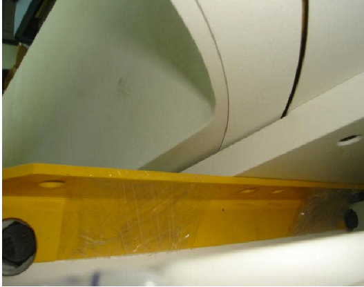
Resim 2.43: Sökülmesi gerekli sarı metal parçalar
