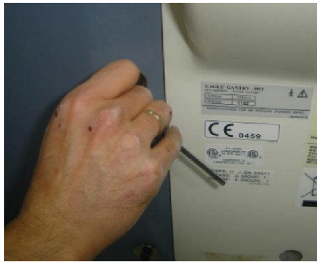
Resim 2.68: Allen anahtarı ile sıkılması-1
