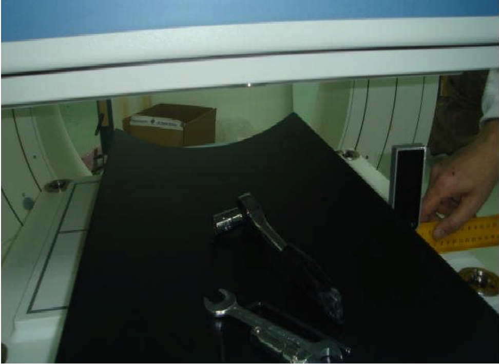
Resim 4.16: Uç noktadan gönye ile ölçüm yapılması
