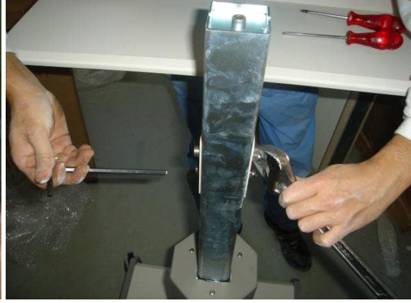
Resim 5.13: Kurbağacık ve Allen ile sıkılması
