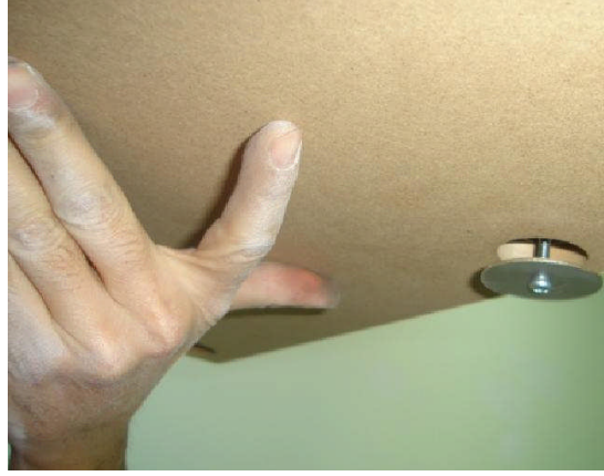
Resim 2.46: Koruma parçalarının vidalarının gevşetilmesi-2
