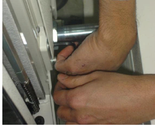
Resim 3.14: Kılavuz pim cıvatalarının gevşetilmesi
