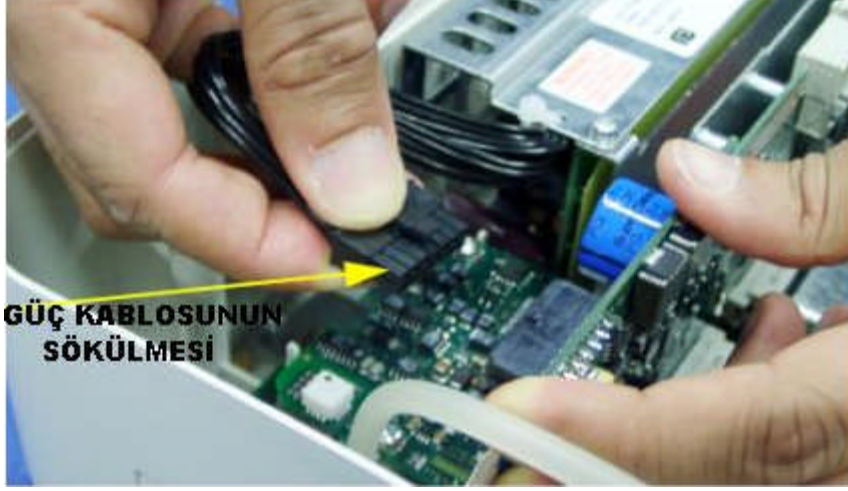
Resim 1.7: Güç modülünün kablo bağlantılarının sökülmesi
