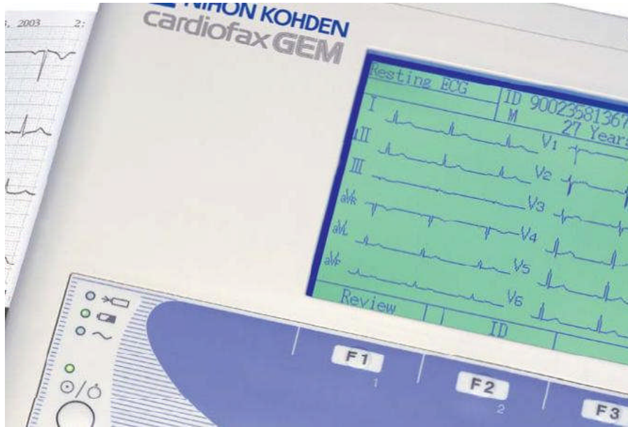
Şekil 3.19: I, II, III, aVR, aVL, aVF, V1, V2, V3, V4, V5, V6 derivasyon grafikleri
