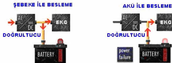
Şekil 1.5: EKG nin şebekeden ve bataryadan beslenmesi
