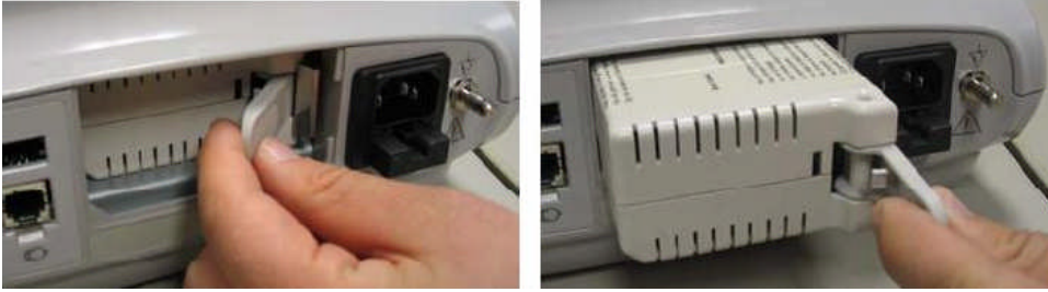
Resim 1.5: Bir EKG cihazının bataryasının çıkarılması
