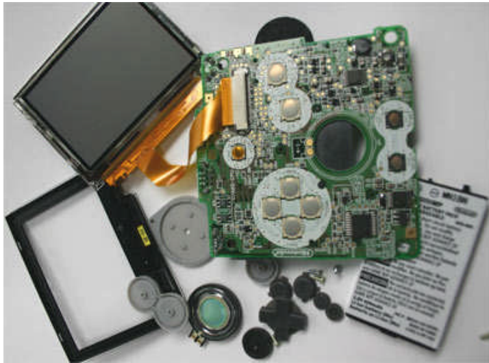
Resim 1.7: Bir LCD ekran ve kontrol devresi
