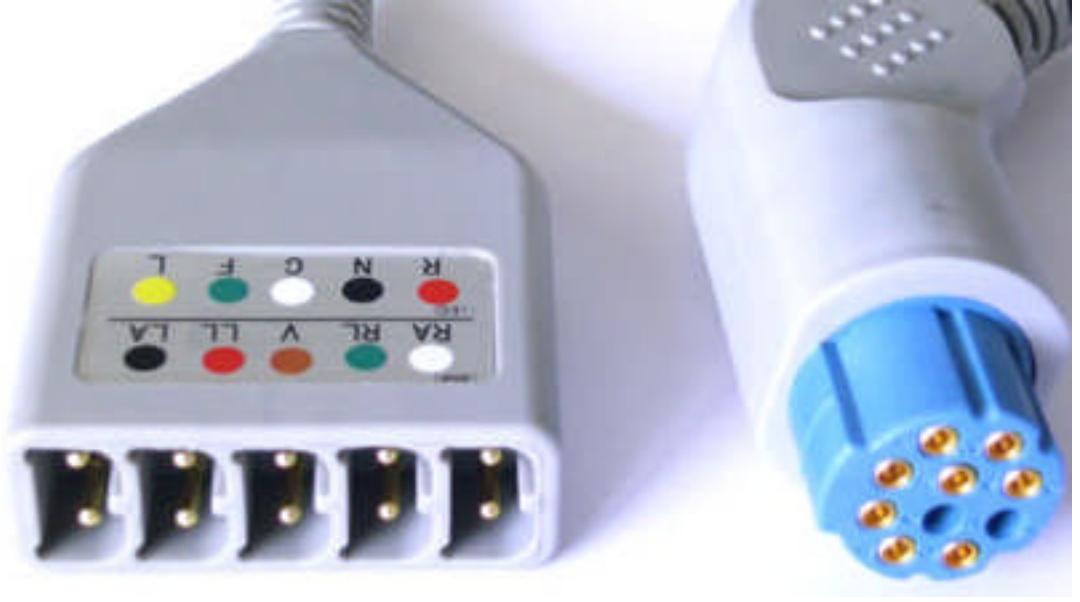
Resim 1.18: Farklı yapıda trunk kablo konnektörü
