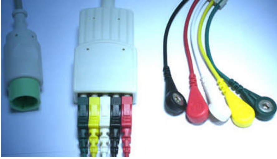
Resim 1.11: Beş lead uyumlu trunk kablo ve EKG leadleri
