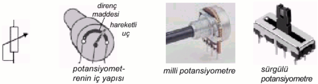
Şekil 4.1: Potansiyometre sembolü, resimde potansiyometrenin iç yapısı ve potansiyometre
