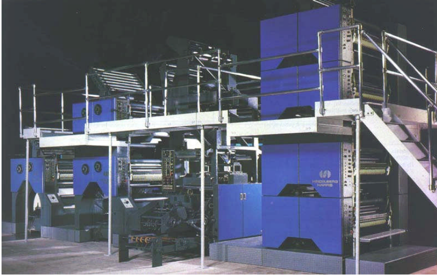
Resim 1.1: Web ofset baskı makinesi
