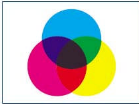
Şekil 1. 1: Çıkarmalı renk karışım sistemi (Cyan, Magenta ve Sarı)
