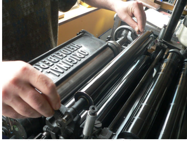
Şekil 2.10: Mürekkep ünitesinin sökümü
