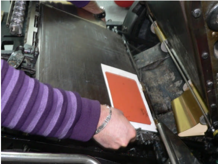
Şekil 1.13: Klişeyi bant ile sabitleme
