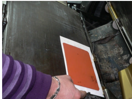
Şekil 1.13: Klişeyi bant ile sabitleme
