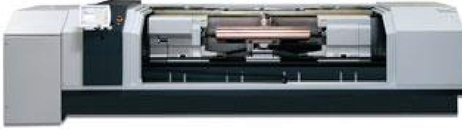
Şekil 2.2 : Lazerle bakıra görüntü aktaran makine
