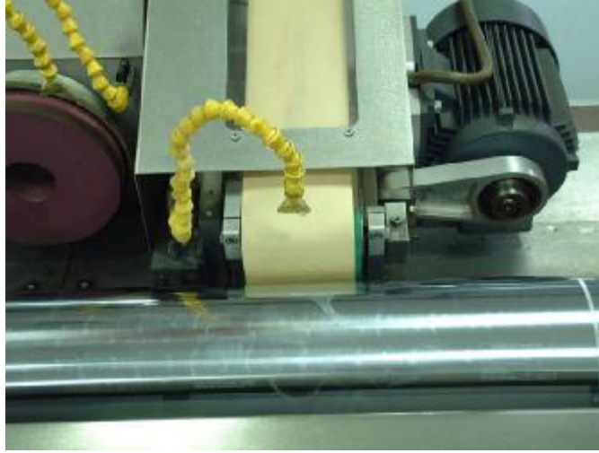
Şekil 1. 27: Silindir yüzeyini pürüzlendirme işlemi
