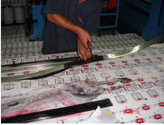
Şekil 3.5 : Sıyrıcı raklenin kesilmesi
