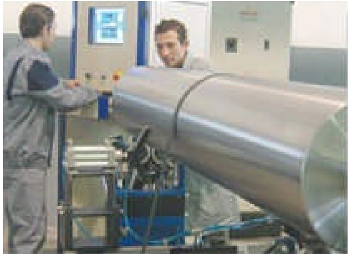
Şekil 2.1: Çelik silindirin hazırlanışı
