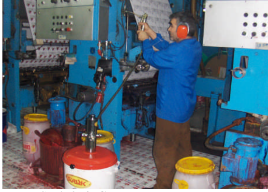
Şekil 3. 4: Gres yağı pompalanması
