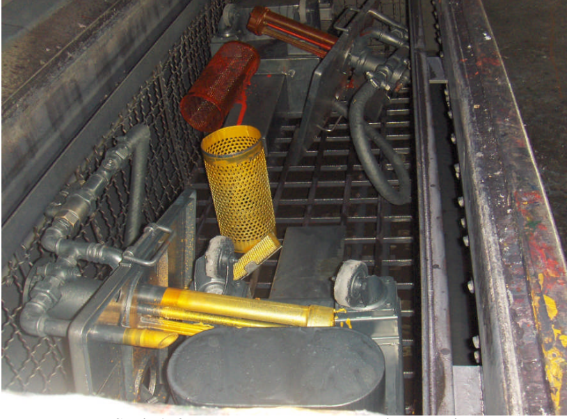
řekil 1. 3: Mürekkep tankının temizlenmesi
