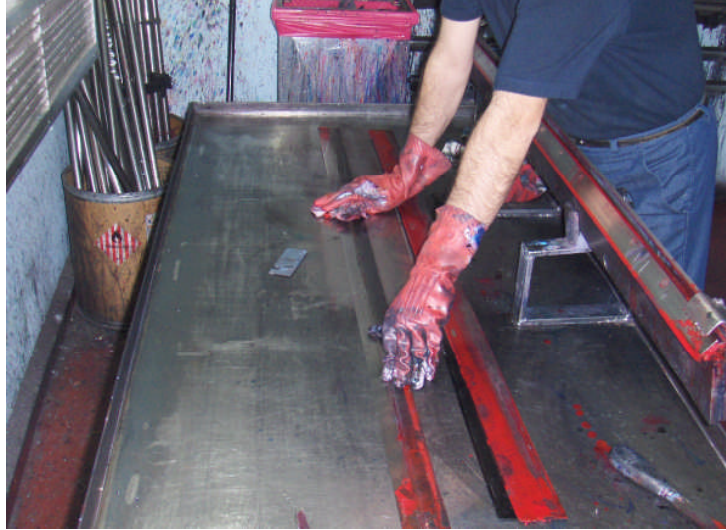
Şekil 2. 1: Sıyırıcı raklenin temizlenmesi
