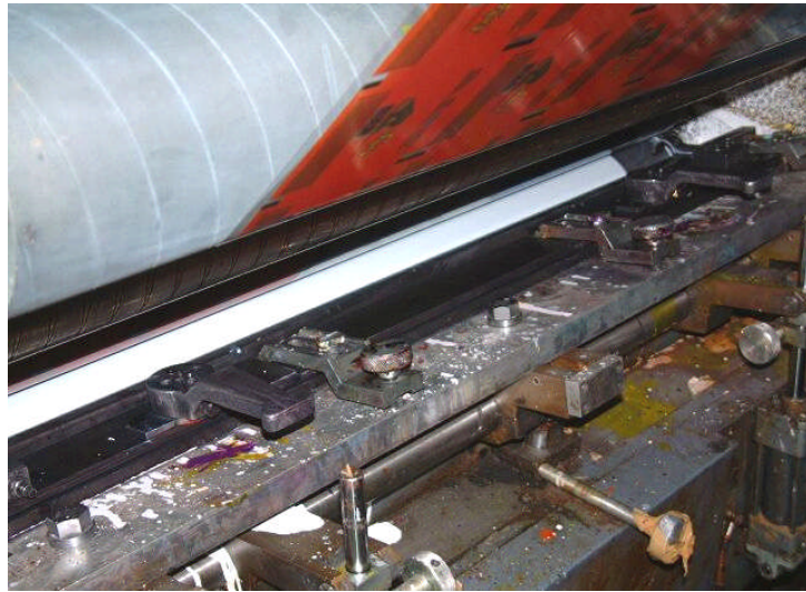
Şekil 1.3: Raklenin baskı makinesinde çalışır hali
