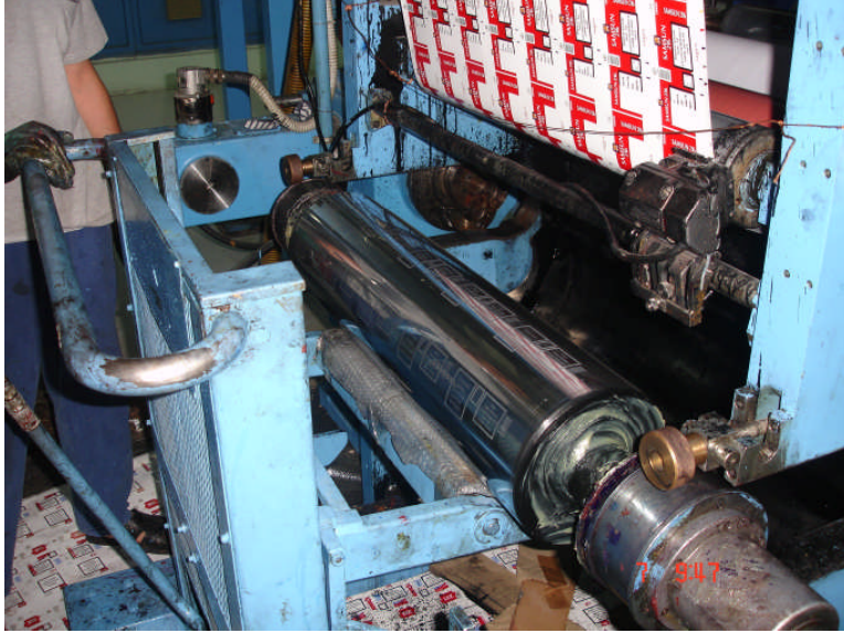
Resim 2.1. :Şaftlı kalıp silindirinin takılması
