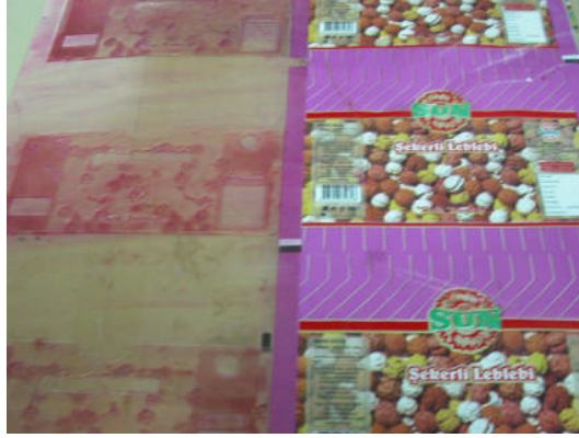
Resim 2.1: Kalıba ve orijinale göre baskı kontrolü
