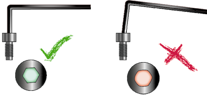
Şekil 3.7 : Alyan anahtarının kullanımı
