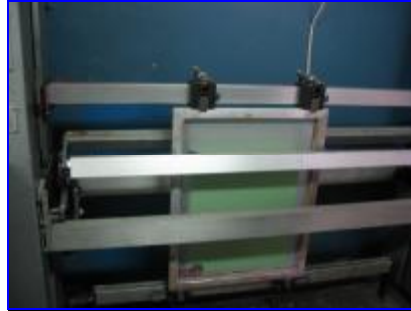
Şekil 1.9: Emülsiyonun otomatik olarak makine tarafından sürülmesi
