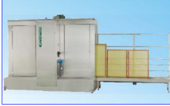
Şekil 3.5: Otomatik kalıp yıkama ve kurutma makinesi
