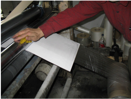
Resim 3.24 : Presyondaki tutkal birikintilerinin bez ile silinmesi
