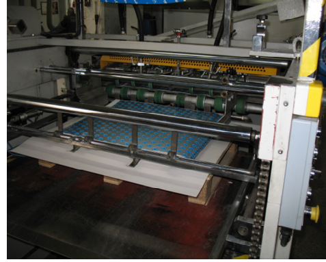
Resim 1.50 : Otomatik selef onlu bobin koparma ünitesi
