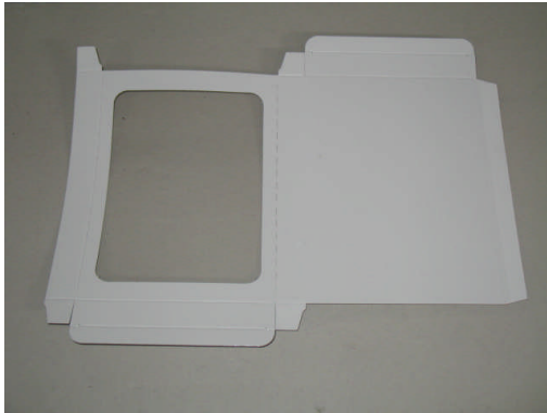
Resim 1.33: Pencerele selefion kaplı bir işin kesilmiş hâli
