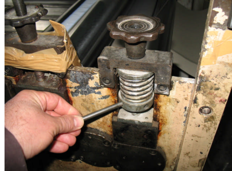
Resim 3.37 : Laminasyon basınç merdane ayarlaması
