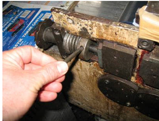
Resim 1.57 :Tutkal sürme kalınlık ayarının yapılması
