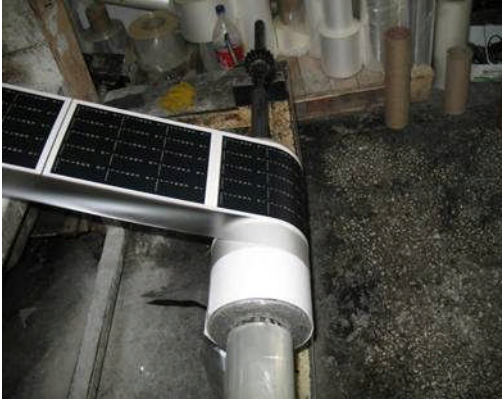
Resim 1.41: Selefona çıkış silindire sardırılması
