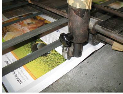
Resim 3.8 : Telefonlu bobinden çarpıtma tekeri ile tabaka koparma
