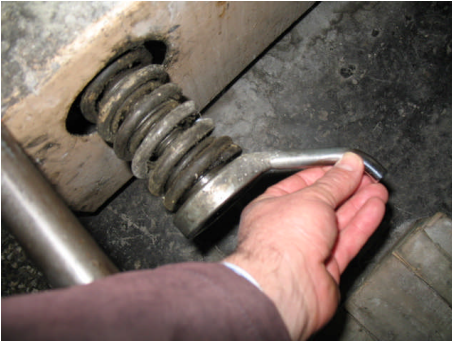
Resim 3.36: Selefona sarım silindiri balata ayarlaması
