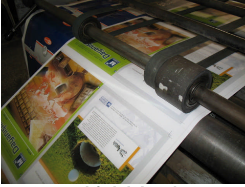
Resim 3.7: Telefonlu bobinin koparma makinesine girişi
