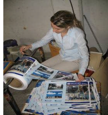
Resim 3.2 : Sefonlu tabakanın bobinden maket bıçağı ile kesimi
