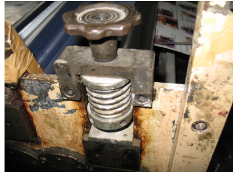
Resim 3.34 : Laminasyon basınç merdane ayarlaması
