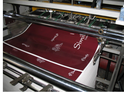
Resim 3.18 :Arka istifte kesilen tabakaların istifi
