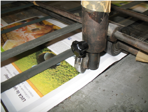
Resim 1.51 : Bobin koparma makinesi çarpıtma tekeri
