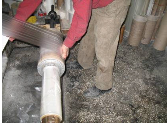
Resim 1.42 : Selefona işlerin çıkış silindire sardırılması
