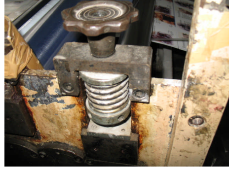
Resim 3.31 : Laminasyon basınç merdane ayarlaması
