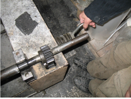
Resim 3.30 :Selefona sarım silindiri balata ayarlaması
