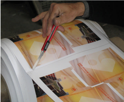
Resim 3.1 : Sefonlu tabakanın bobinden maket bıçağı ile kesimi
