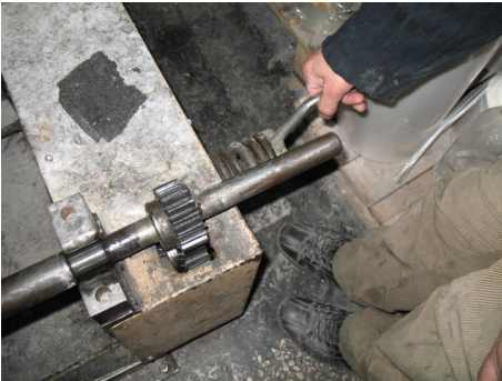
Resim 3.33 : Selefona sarım silindiri balata ayarlaması
