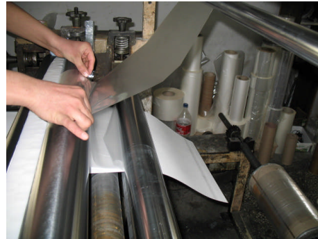
Resim 3.42 : Selefona tutkal içinden verilmesi
