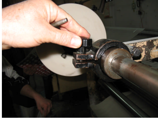
Resim 1.58 :Tansiyon gerginlik ayarının yapılması
