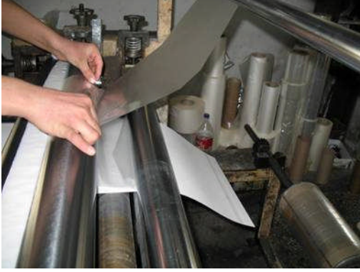
Resim 1.35: Pencerele telefon kaplamada telefonun akış yolu (Takıldığı yerden makaralar ile presyona girer.)
