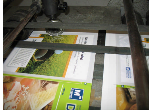
Resim 3.10: Koparılmış tabaka çıkış istifine giderken
