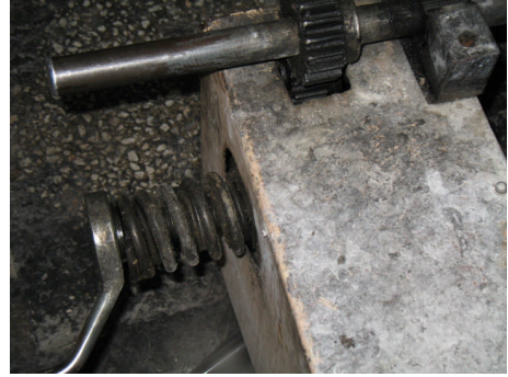
Resim 3.28:Balata mekanizmasının gerdirilmesi
