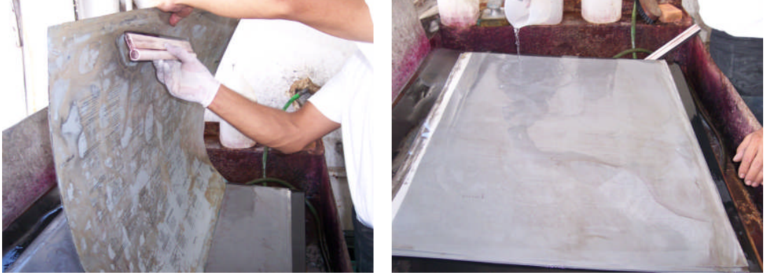
Resim 3.9: Kalıp üzerindeki emaye artıklarının su ve rakel ile temizlenmesi
