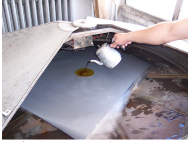
Resim 1.2: Dönen kalıp üzerine emaye dökülmesi
