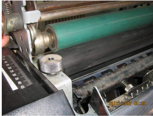
Resim 2.4: Su haznesi sökülmüş ünite
