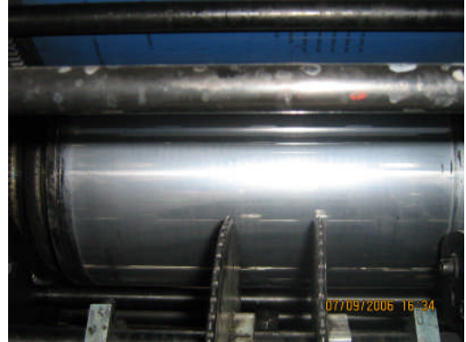
Resim 1. 4: Baskı kazanı ve makaslar
