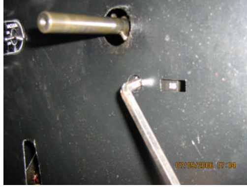
Resim 1.7: Forsa ayar yeri ve anahtarı
