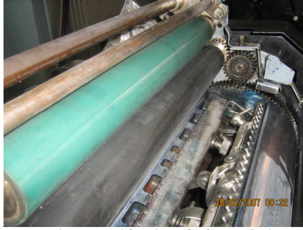
Resim 2.5: Temizlenmiş nemlendirme ünitesi
