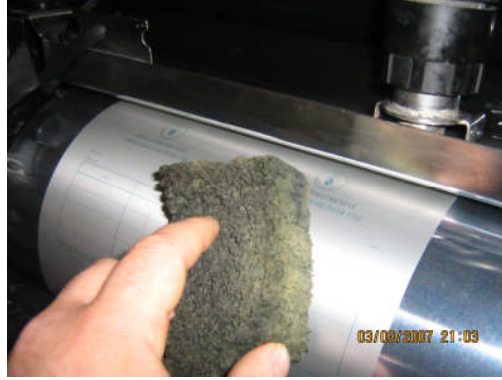
Resim 2.7: Kalıp temizleme işlemi
