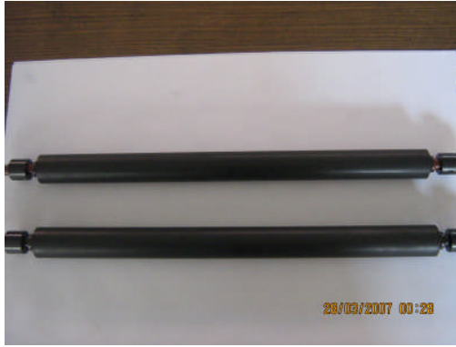
Resim 2.3: Temizlenmiş plastik merdanele
