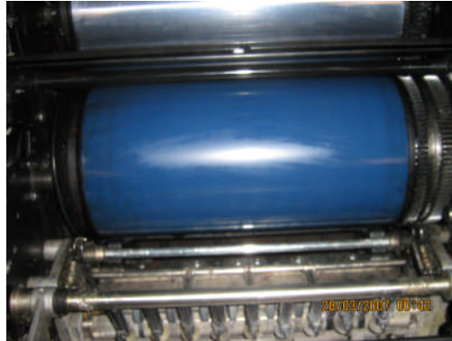
Resim 2. 9: Temizlenmiş kauçuk kazanı
