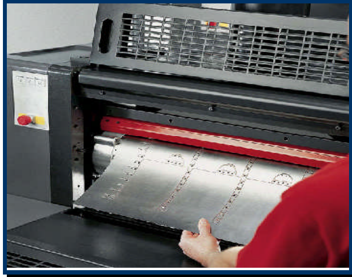
Resim 1.2: Şekli kesim bıçak kalıbının makineye bağlanması
