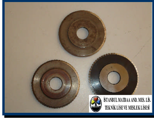
Resim 2.2: Ofset baskıda kullanılan dikey piliyaj ve perforaj bıçakları
