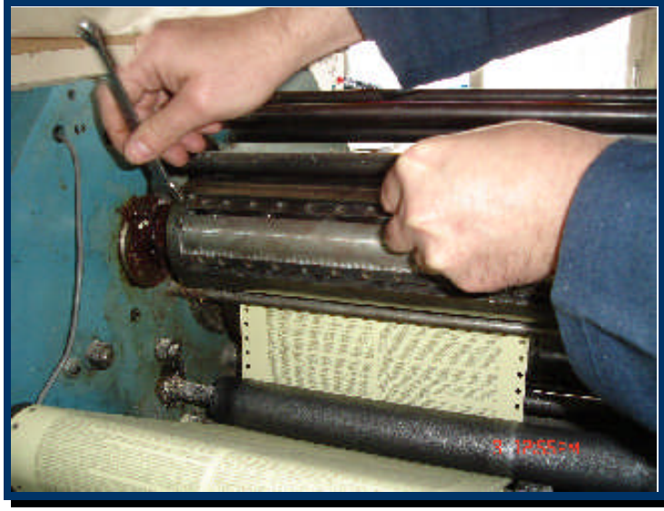
Resim 1.4: Kesim bıçağının lamalara takılması
