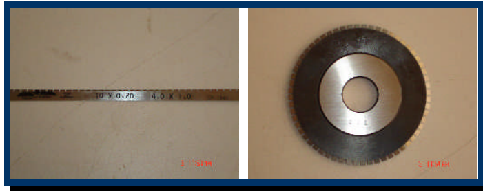
Resim 2.3: Ofset baskıda kullanılan perforaj bıçakları
