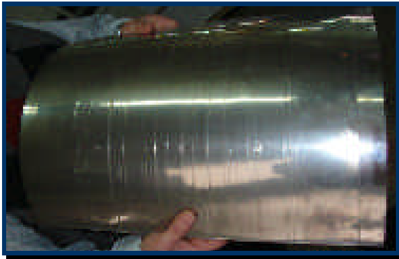
Resim 1.7: Ofset baskı makinesi kesim yapan ünitenin baskı kazanı kılıfı
