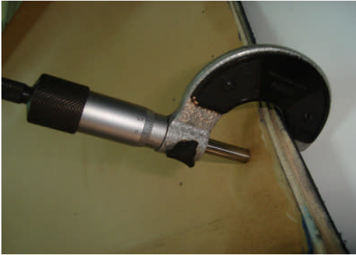
Resim 2.5: Kauçuk ve alt beslemenin kalınlığının ölçümü ve kauçuğun kazana takılması
