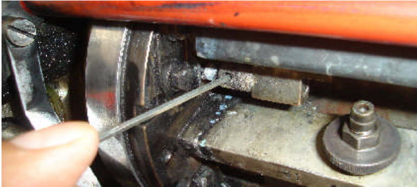
Resim 1.4: Kalıp çarpıtılma ayarı
