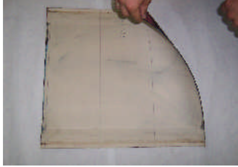
Resim 2.2: Ofset baskı makinesinde kauçuğun görüntüsü
