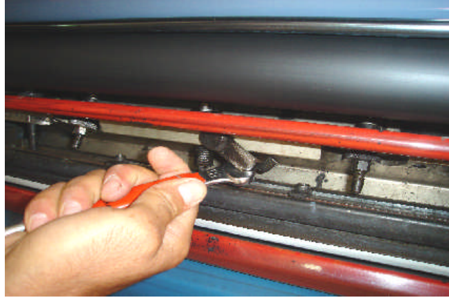
Resim 1.3: Kalıbın anahtar yardımıyla gerdirmesi
