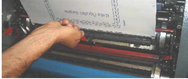
Resim 1.2: Kalıp kazanında kalıp tutucu lamalar
