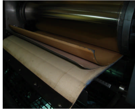
Resim 2.5: Kauçuk ve alt beslemenin kalınlığının ölçümü ve kauçuğun kazana takılması
