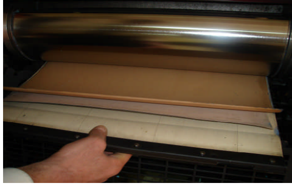
Resim 2.1: Ofset baskı makinesinde kauçuk kazanının görüntüsü
