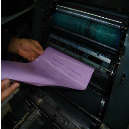
Resim 10: Banyo işlemi tamamlanmış bir kalıbın makineye takılması
