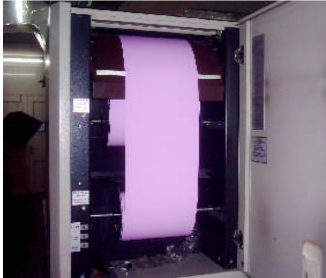
Resim 4: Elektrostatik kalıbın makineye takılırkenki görünümü
