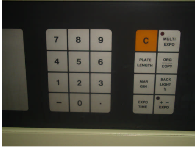
Resim 3: Kalıp pozlandırılmada poz süresini belirleyen düğmeler
