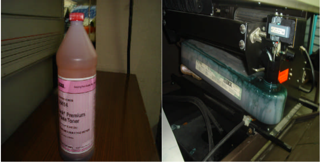
Resim 5: Tonerin şişedeki ve kalıp makinesine konmuş hâli
