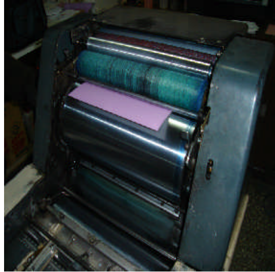
Resim 10: Banyo işlemi tamamlanmış bir kalıbın makineye takılması
