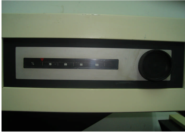
Resim 2: Pozlandırma cihazında küçültme ve büyültme işlemi yapılabilmektedir.
