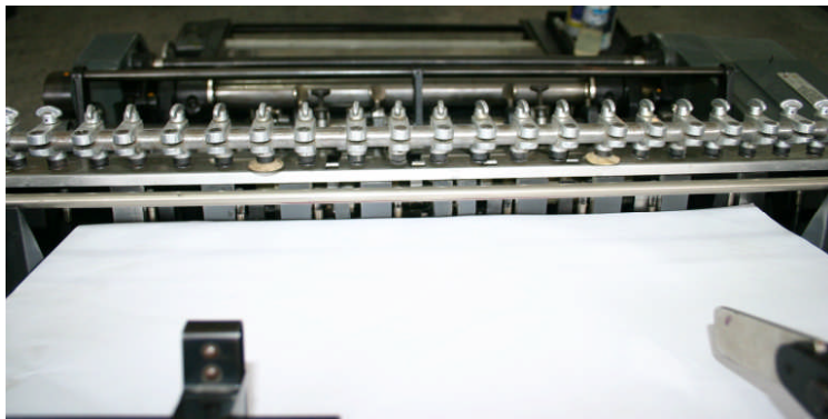
Resim 2.2: Kâğıt ölçüsündeki emiciler açılıp ölçü dışındaki emiciler kapatılmalıdır.
