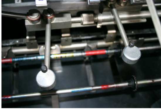
Resim 1.15: Çıkış asansöründeki üfleyiciler kâğıdın düzgün istiflenmesini sağlar.
