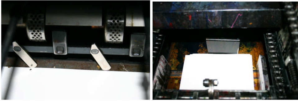
Resim 1.12: Kâğıt ön ve arkadan düzgün istiflenmesi için hareketli kâğıt toplayıcı
