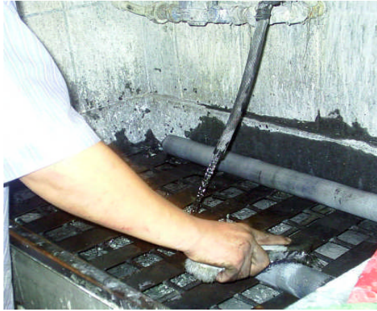
Şekil 2.11: Su merdanesinin temizlenmesi
