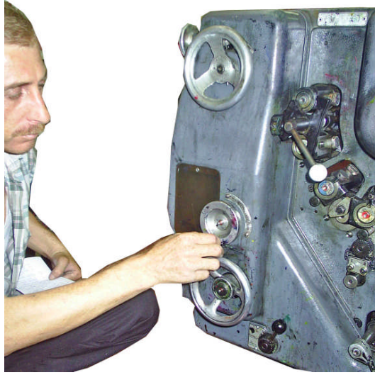
Şekil 1.7: Hazne merdanesi dönüş ayarının Yapılması
