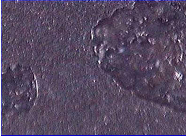
Resim 1.4 : Kimyasal yolla oyulmuş çelik klişe
