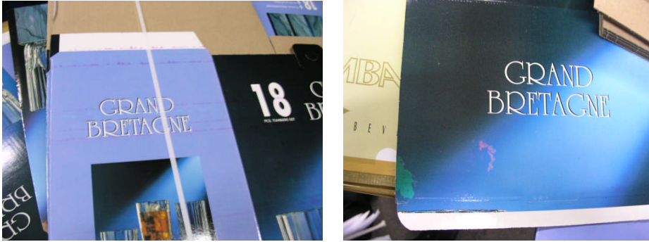
Resim 3.5: Baskı yüzey çizilmesi baskı lekesi kutu örneği
